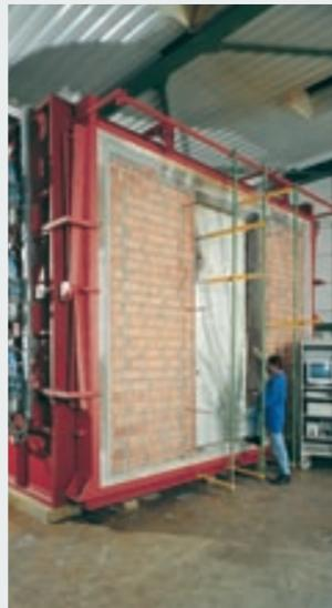
Im Brandhaus unseres Labors messen hochempfindliche Geräte exakt die thermische Belastbarkeit. So lassen sich Neuentwicklungen in jeder Phase erproben und optimale Voraussetzungen schaffen für die externe Prüfung und die Erteilung der amtlichen Zulassung.
