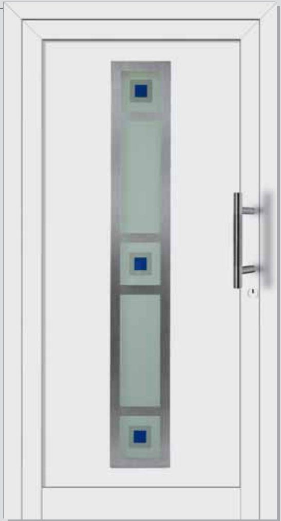
Aluminium-Füllung, Griff 14-1, Iso-Glas, außen VSG klar, innen Float sandgestrahlt mit blauen Applikationen im Scheibenzwischenraum.
