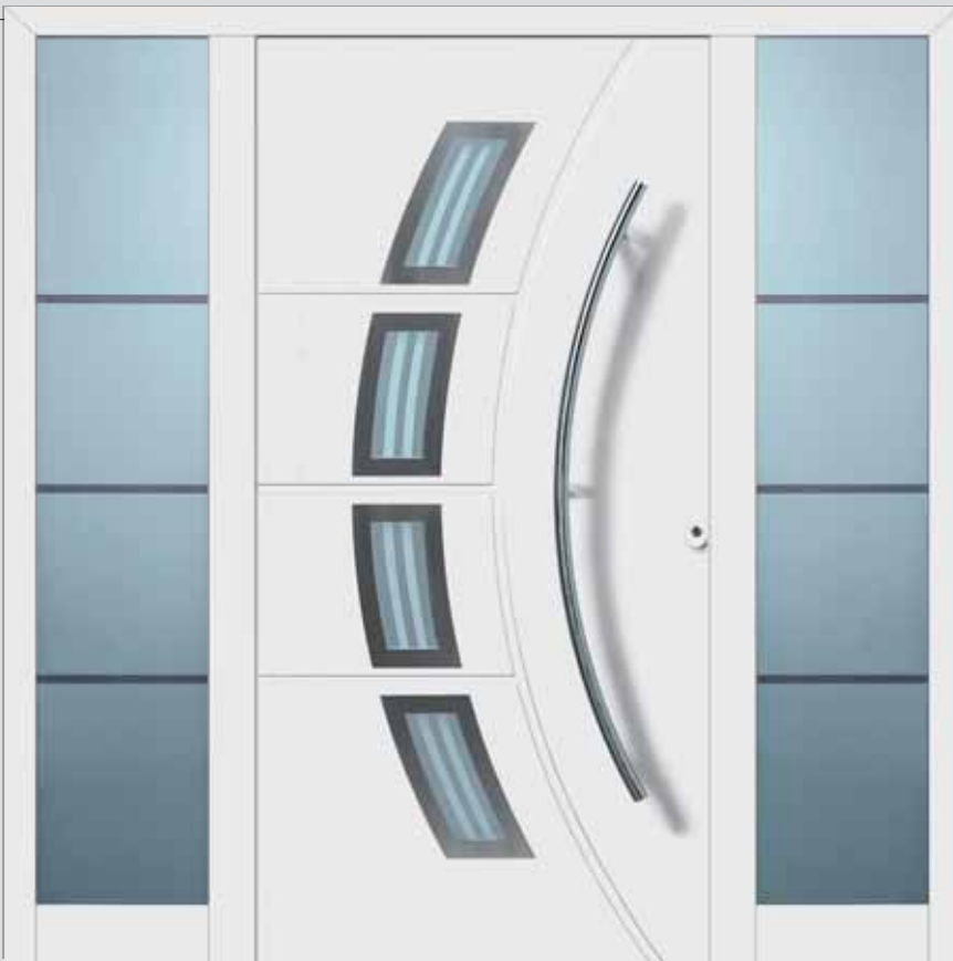
Edelstahlgriff auf Aluminium-Füllung. Iso-Glas, außen VSG klar, innen Stopsol grau mit sandgestrahlten Streifen.
