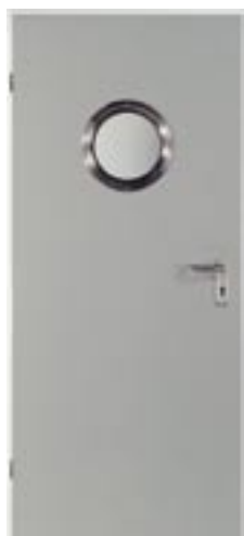
Dveře ZK/OIT Kruhové prosklení ø 300 mm Rám prosklení z hliníku eloxovaného v přírodním odstínu (E6/EV1), na přání z vyleštěné ušlechtilé oceli (obrázek)
